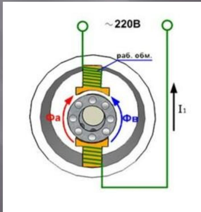
Запуск двигателя производится с помощью пусковой обмотки, включенной в сеть через фазосдвигающий элемент
