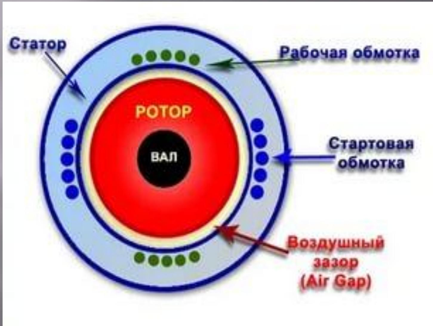
Принцип работы двигателя основан на свойстве однофазного тока создавать пульсирующее магнитное поле, которое можно рассматривать, как два вращающихся на встречу поля.
