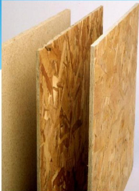
Древесностружечные плиты (ДСП) изготавливают на специальных машинах прессованием стружки, смешанной с синтетической смолой.
