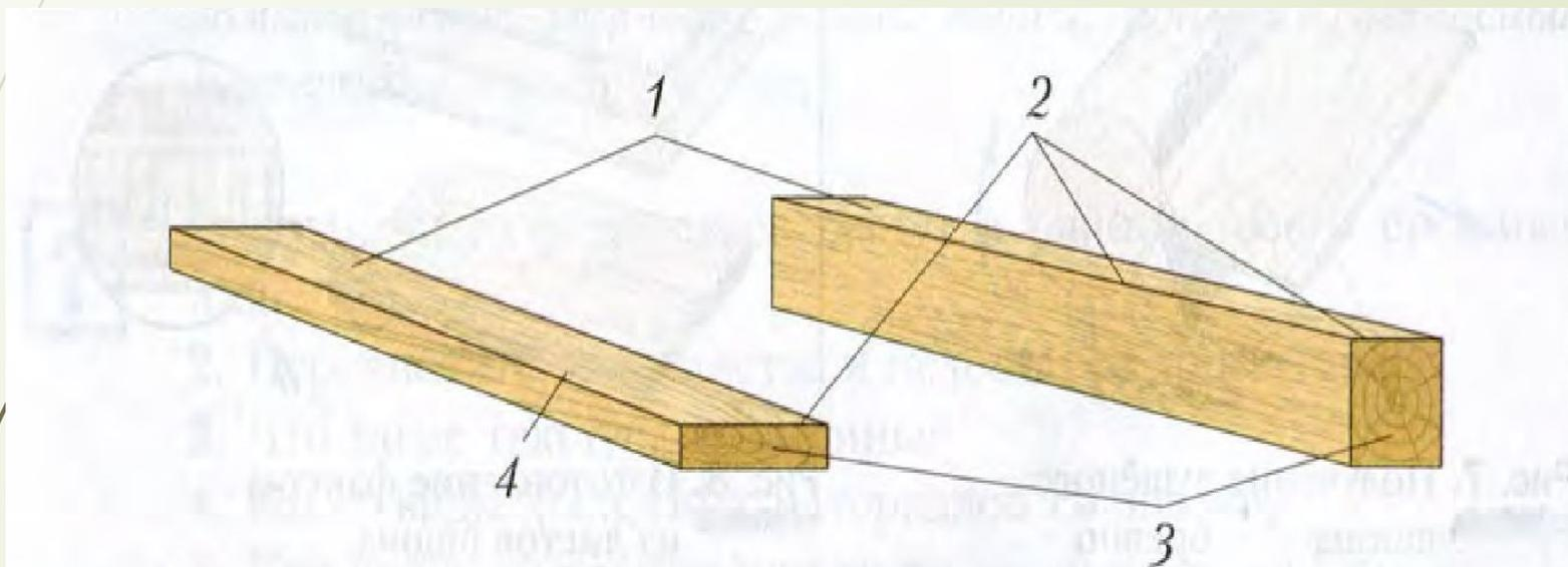
Рис. 6. Элементы пиломатериалов: 1 – пласть; 2 – ребро; 3 – торец;
