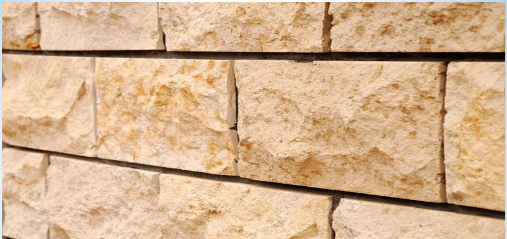
**Известняк используют при строительстве зданий и дорог. Из него получают известь, которую применяют для приготовления строительных растворов (ими скрепляют кирпичи, штукатурят стены).**
