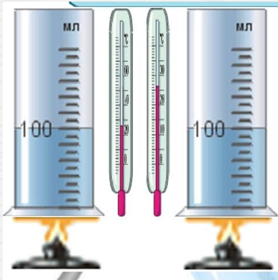
Теперь в одну пробирку нальём воды, а в другую — подсолнечное масло той же массы и температуры, что и вода. Обе пробирки поместим в сосуд с горячей водой. Наблюдая за показаниями термометров, мы увидим, что масло нагревается быстрее. Чтобы нагреть воду и подсолнечное масло до одной и той же температуры, воду следует нагревать дольше. Но чем дольше мы нагреваем воду, тем большее количество теплоты она получает от нагревателя (горячей воды в сосуде).
