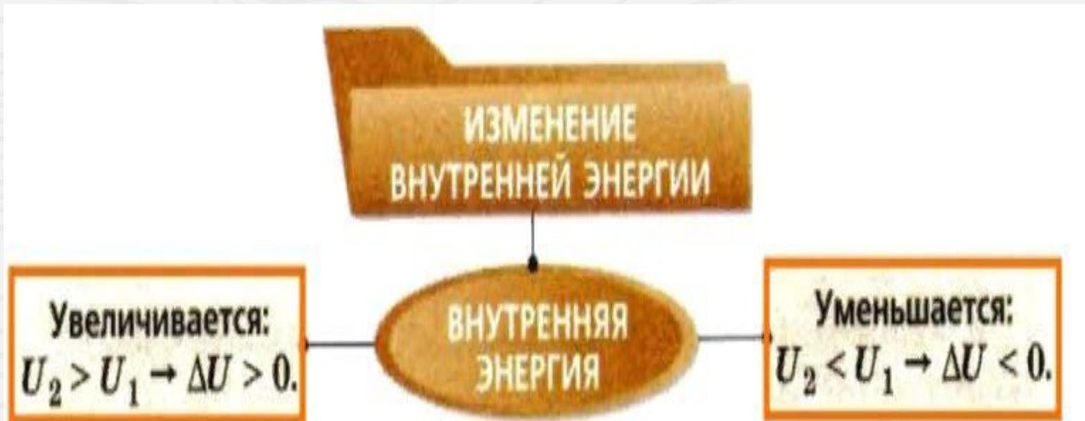
Если внутренняя энергия тела изменилась за счёт совершённой работы, то изменение внутренней энергии равно совершённой работе  $A$ . Если же изменение произошло за счёт теплопередачи, то для характеристики этого процесса вводится понятие количество теплоты -  $Q$
