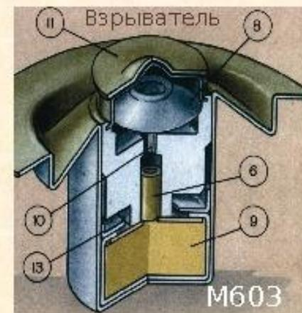
Поражение машинам противника наносится за счет разрушения их ходовой части при взрыве заряда мины в момент наезда колеса (катка) на нажимную крышку мины (**взрыватель М603 химический**) или наклона взрывателя (**взрыватель М624**).
