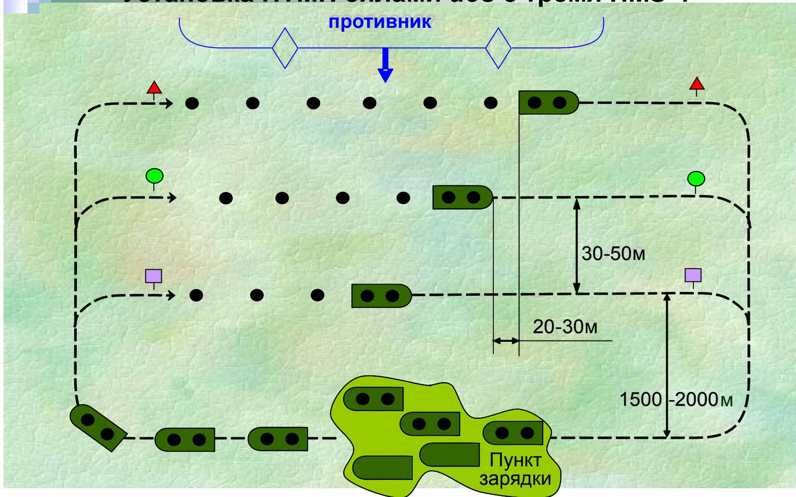
Время на установку 1-го б/к (600 мин ТМ-62) *исв* с тремя ПМЗ-4 при выдвигении на рубеж минирования и зарядкой – 1-1,5 ч. За 10-12 ч. вне соприкосновения с противником *исв* может установить 3-4 б/к
