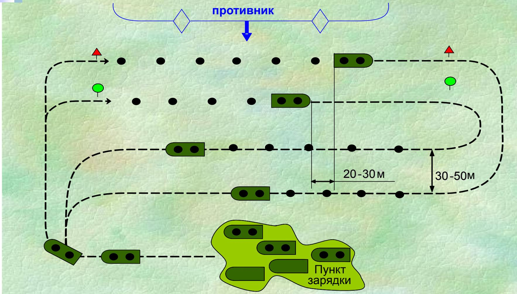
Время на установку 1-го б/к (400 мин ТМ-62) *исв* с двумя ПМЗ-4 при выдвигении на рубеж минирования и зарядкой – 1,5 ч.
