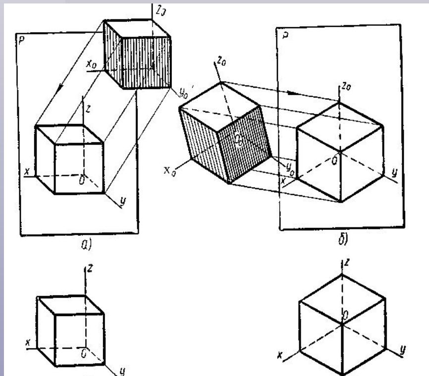
Все прямые линии, параллельные между собой на объекте, остаются на изображении параллельными. В техническом черчении и рисовании наибольшее применение получили:
