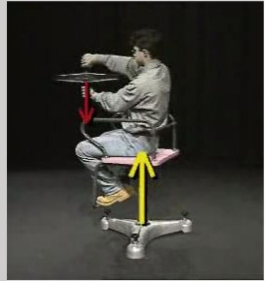
Экспериментатор поворачивает ось колеса на  $90^\circ$  так, что вектор момента импульса направлен вниз. Скамья начинает вращаться в противоположную сторону, как в опыте 1.
