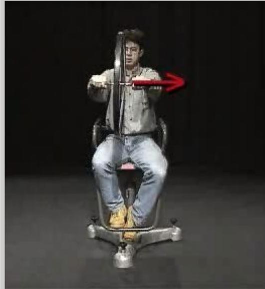
Экспериментатор поворачивает колесо так, что вектор момента импульса направлен горизонтально. Скамья и человек остаются в покое, т.к. проекция момента импульса колеса на вертикальную ось равна нулю.
