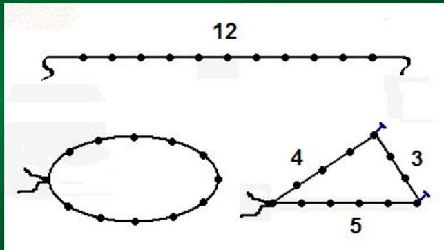
Бечевку узлами делили на 12 равных частей и концы связывали. Затем бечевку растягивали на земле так, чтобы получался треугольник со сторонами 3, 4 и 5 делений.
