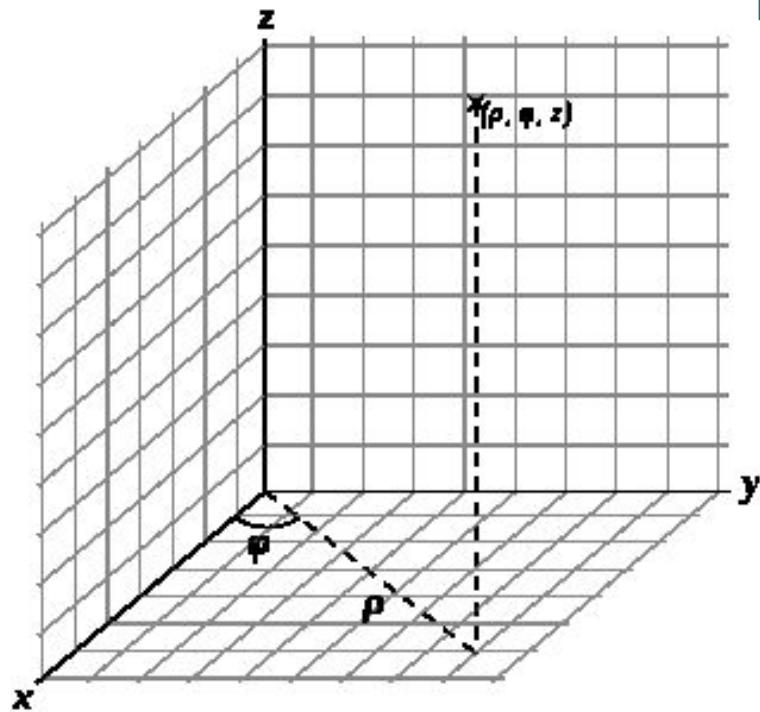
Цилиндрическая система координат
