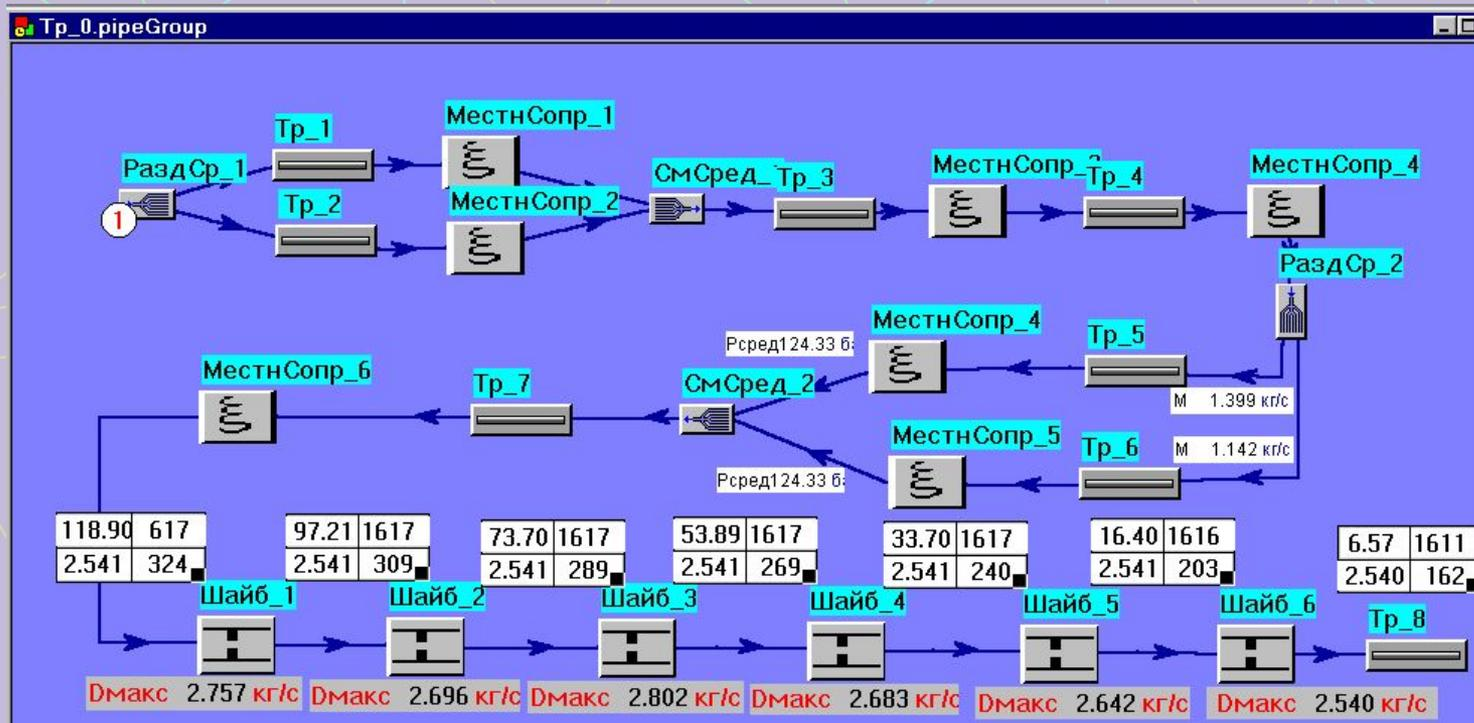
Минимальный критический расход на шайбе №6 ограничивает пропускную способность трубопровода
