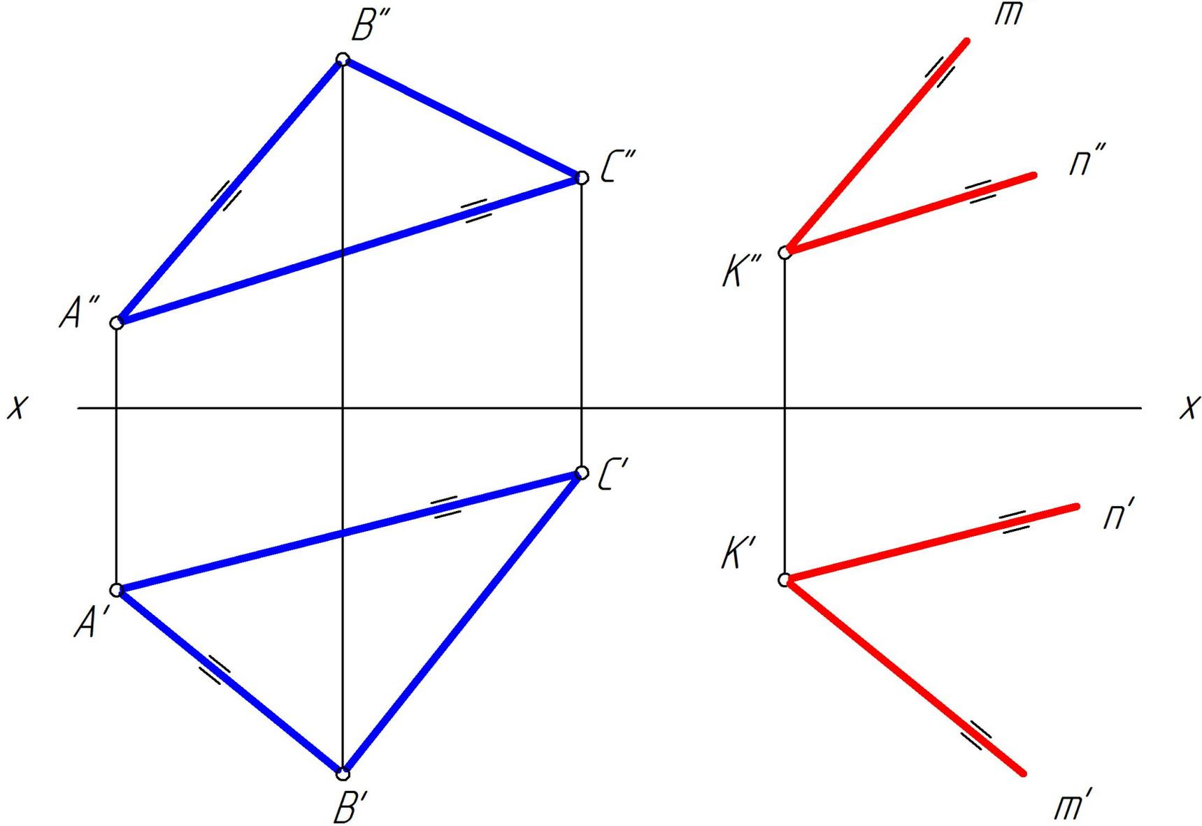
**Построить через точку  $K$  плоскость, параллельную
