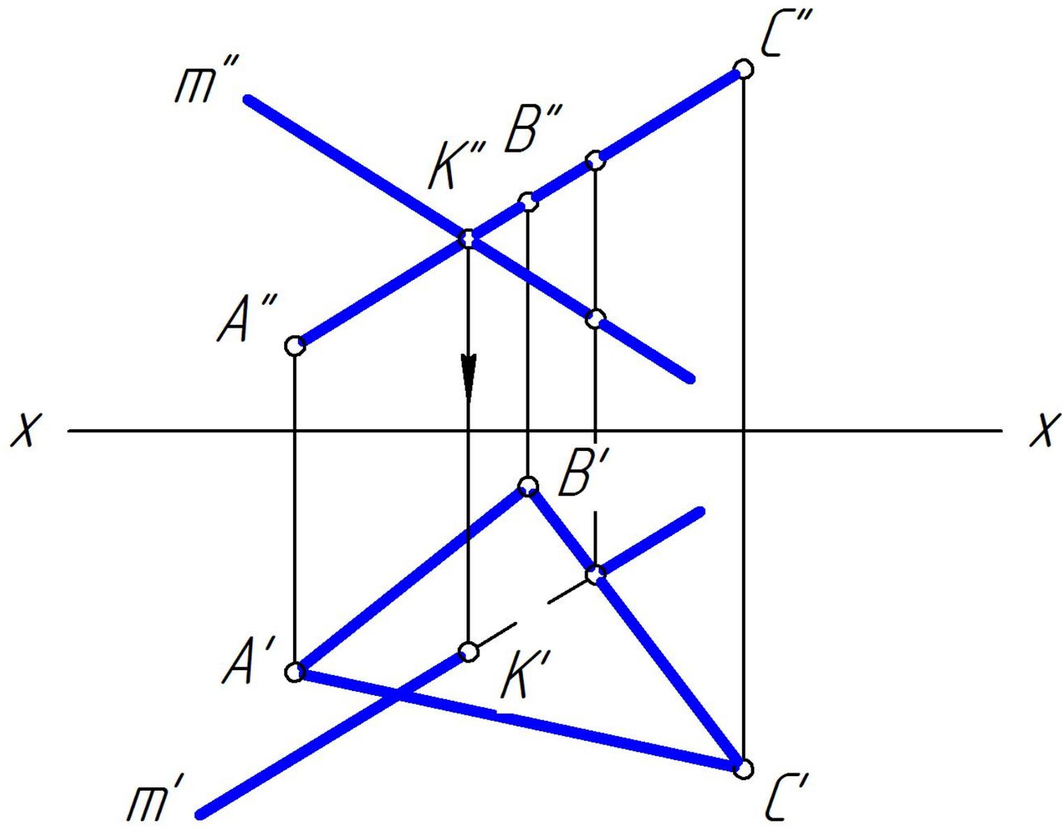
**Построить точку пересечения горизонтально проецирующей прямой  $m$  с плоскостью**
