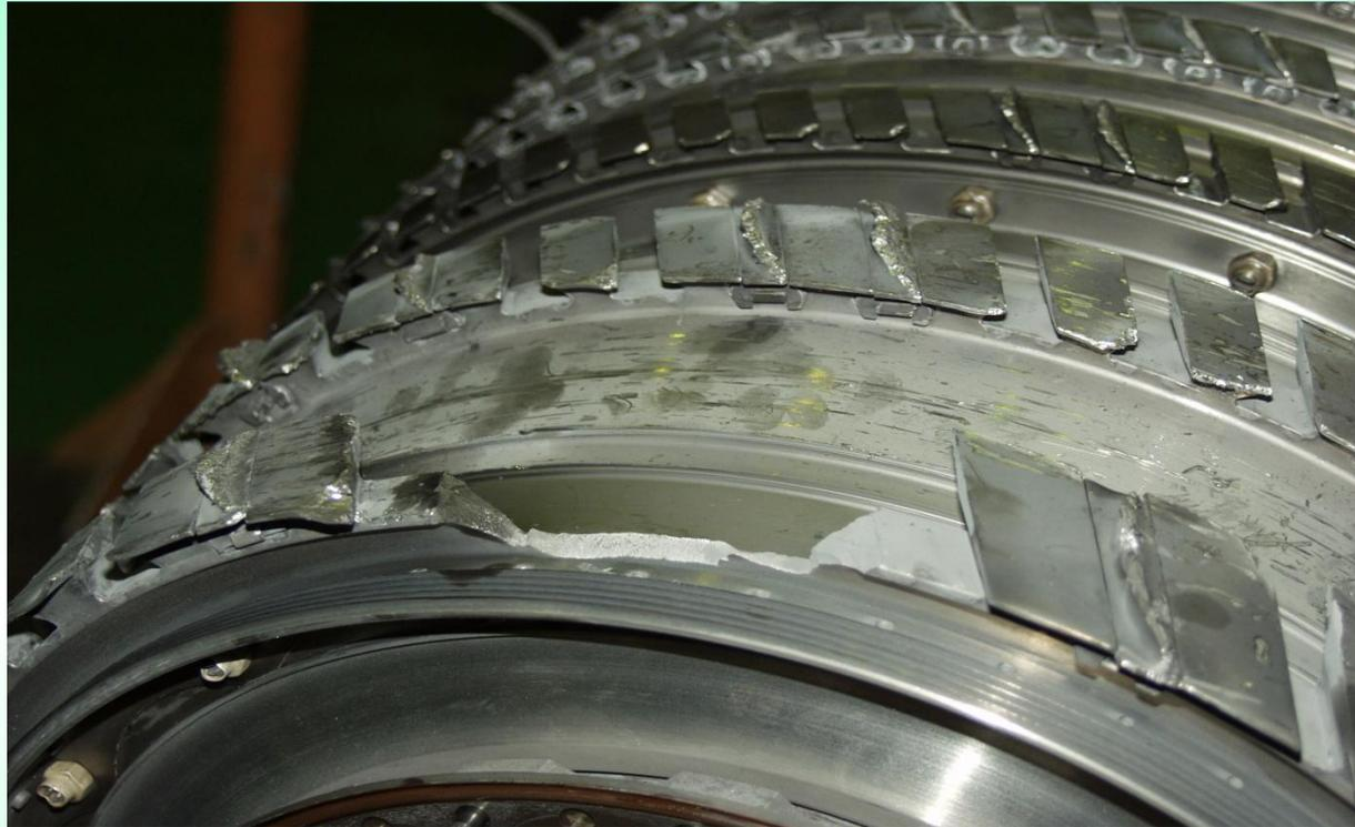
*\* История эксплуатации данного рабочего колеса в составе ротора компрессора низкого давления имеет случаи разрушения диска от основания межпазового выступа.*
