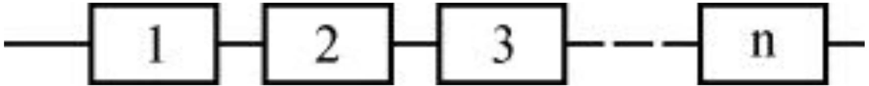
С позиции надежности, такое соединение означает, что отказ устройства, состоящего из этих элементов, происходит при отказе элемента 1 или элемента 2, или элемента 3, или элемента n.
