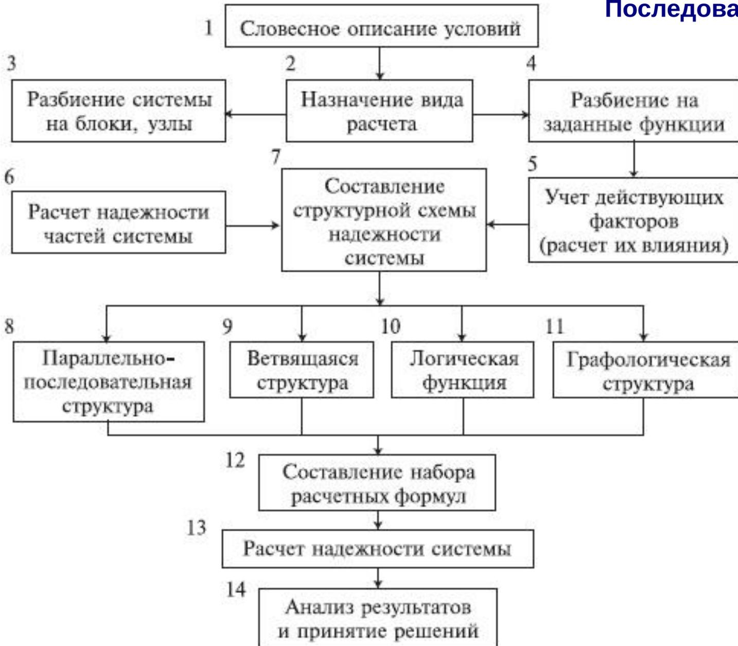
Под **структурной схемой надежности** понимается наглядное представление (графическое или в виде логических выражений) условий, при которых работает или не работает исследуемый объект (система, устройство, технический комплекс и т.д.).
