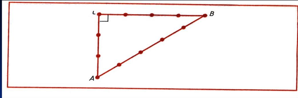
В точке С где надо было построить прямой угол, забивали колышек, веревку натягивали в направлении, нужном строителям, забивали колышек в точке В при  $CB = 4$  и натягивали веревку так, чтобы  $AC = 3$  и  $AB = 5$ . Треугольник с такими длинами сторон называют египетским. Мы, конечно, понимаем, что безошибочность такого построения следует из теоремы, обратной теореме Пифагора.
