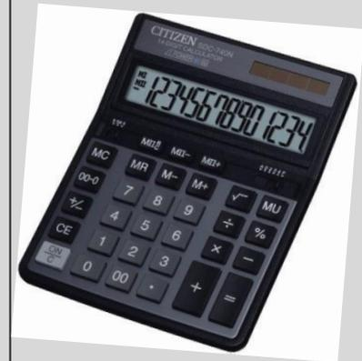
**ИНЖЕНЕРНЫЕ** предназначены для сложных научных и инженерных расчётов. Имеют большое количество функций, включая вычисление всех элементарных функций, статистические расчёты, задание углов в градусах, минутах и секундах.
