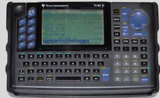
ГРАФИЧЕСКИЕ КАЛЬКУЛЯТОРЫ имеют графический экран, что позволяет чертить [графики функций](#) или даже выводить на экран произвольные рисунки.
