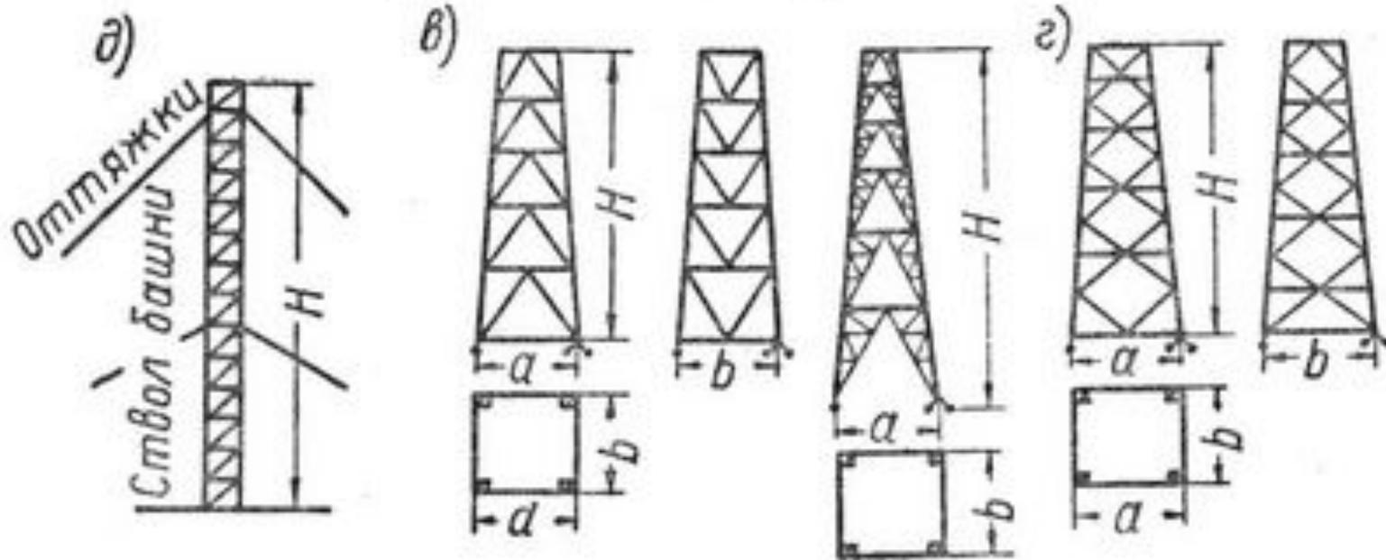
в — башня с полураскосной решеткой на болтах и гвоздях (применяются в случаях, перечисленных в п. б, а также в качестве радиобашен.  $b/H=1/1 \div 1/8$ ;  $H_{\text{макс}} = 40 \div 200$  м);
