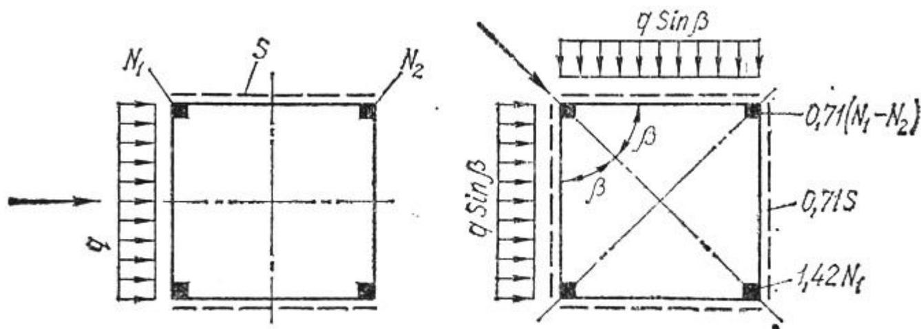
Рис. 170. Загружение башни ветром:
