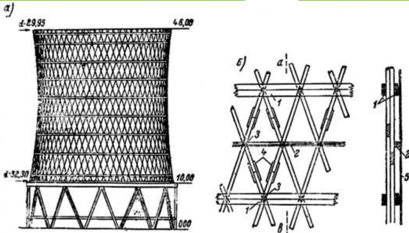
Соединение стержней башни в местах пересечения выполняется при помощи болтов. Стыки стержней по длине перекрываются деревянными накладками на гвоздях. Для обеспечения поперечной жесткости башни и устойчивости отдельных стержней на расстоянии 5-6 м ставятся жесткие кольца. Для таких сетчатых башен может применяться как пиленый, так и круглый лес.
