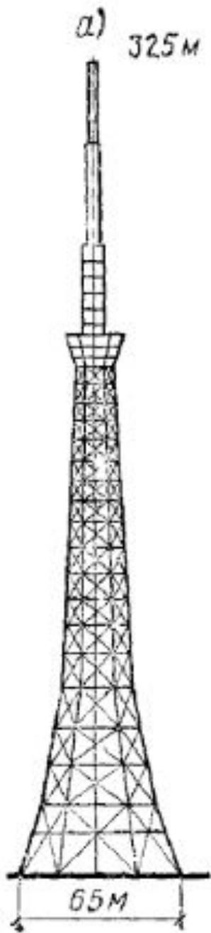
Высотными принято называть сооружения, высота которых намного превышает их размеры в поперечном сечении.
