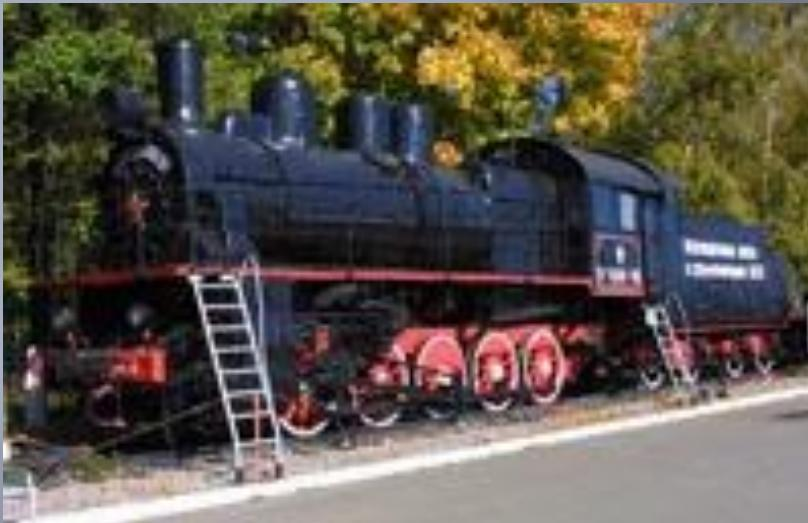
Паровоз серии Эу средней мощности, предназначен для обслуживания пассажирских и грузовых составов. Паровозы этой серии отличались мощностью и надёжностью, способностью работать на любом виде топлива. Именно этому локомотиву было суждено стать основным фронтовым паровозом. Вес 85т
