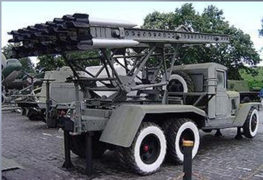
Оружие относительно простое, состоящее из направляющих рельсов и устройства их наведения. Для наводки были предусмотрены поворотный и подъёмный механизмы и артиллерийский прицел. В задней части машины находились два [домкрата](#), обеспечивающие большую устойчивость при стрельбе.
