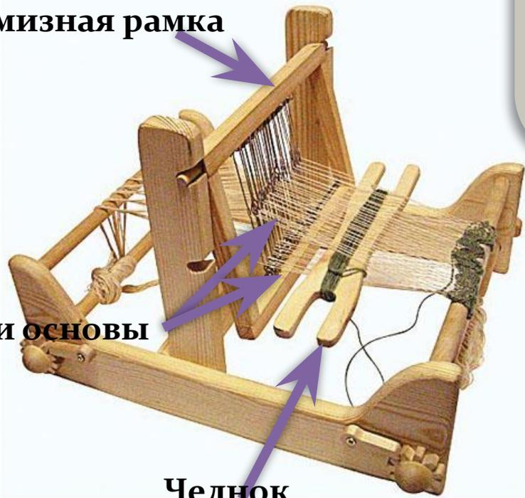
Имя изобретателя первого ткацкого станка неизвестно. Однако принцип, заложенный этим человеком, жив до сих пор: сначала ремизная рамка поднимает четную часть нитей, потом в образовавшийся зев продевают челнок, затем 2 ремизная рамка поднимает нечетную часть нитей основы, а четные опускаются, челнок проходит в образовавшийся зев снова.
