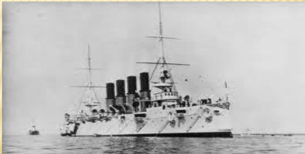
Это был четырех - трубный, двухмачтовый, бронепалубный крейсер 1 ранга водоизмещением 6500 тонн. Артиллерия главного калибра крейсера состояла из двенадцати 152-мм (шестидюймовых) орудий. Кроме того, на корабле было двенадцать 75-мм орудий, восемь 47-мм скорострельных пушек и две 37-мм пушки. Крейсер имел шесть торпедных аппаратов. Он мог развивать скорость до 23 узлов
