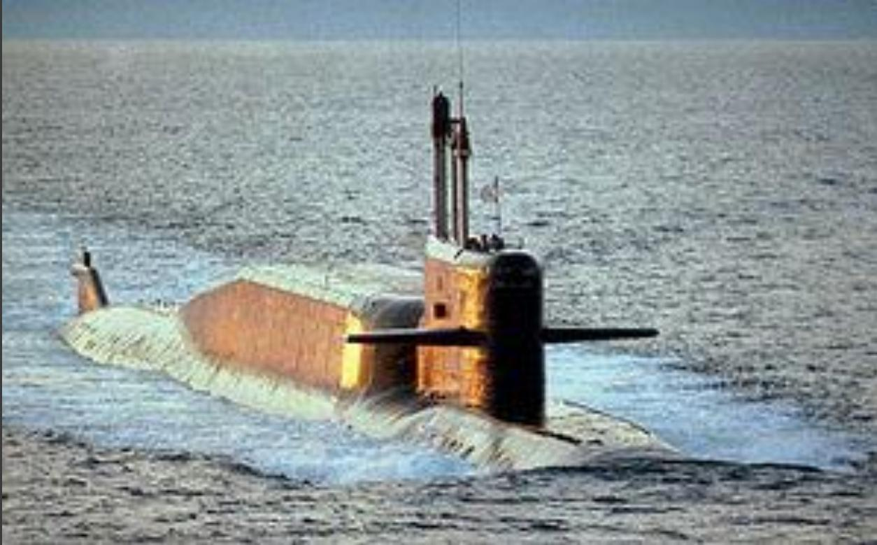
**Подводный крейсер** — подводная лодка, приспособленная и предназначенная для долгих одиночных автономных походов. Как правило отличается большим водоизмещением и лучшими условиями обитания экипажа.
