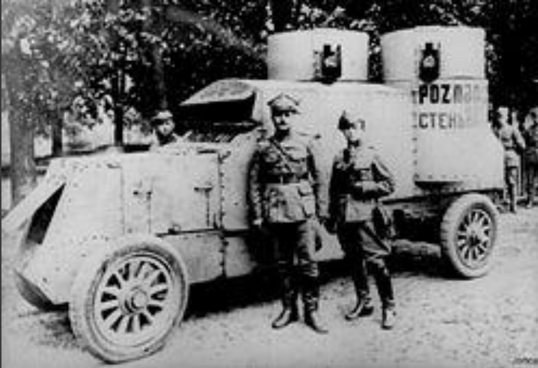
**Бронированный автомобиль** (сокр. бронеавтомобиль, уст. блиндированный автомобиль, простореч. броневик) — тип специального военного автомобиля с бронированным корпусом и пулемётным или пушечным вооружением.
