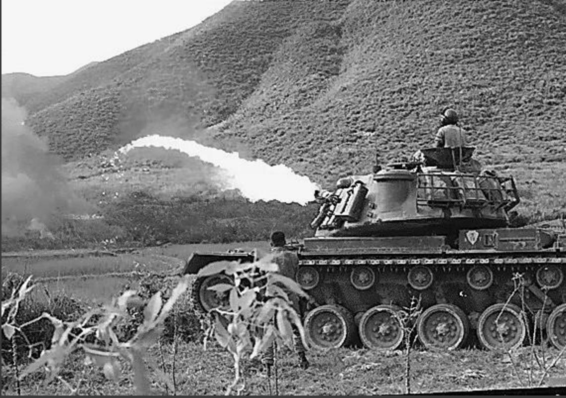
**Огнемётный танк** — танк, или, реже, другая бронированная машина, чьим основным вооружением является огнемёт. Основное его назначение — поддержка пехоты при штурме укреплённых позиций противника. Как правило, огнемётный танк создаётся на основе линейного танка путём установки огнемёта на месте основного или вспомогательного вооружения (в отличие от боевой машины огнемётчиков, где огнемёт является вооружением команды огнемётчиков, а не самой машины).
