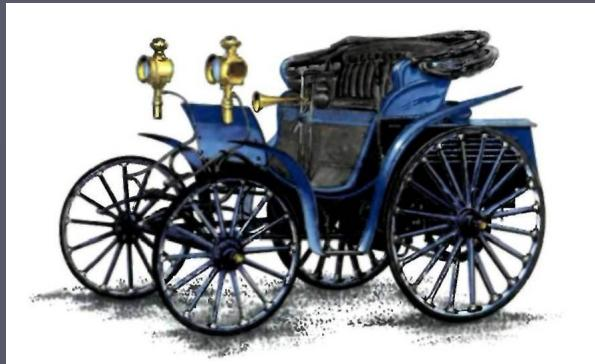
29 января 1886 года изобретатель получил Германский императорский патент на «экипаж с газовым мотором» под названием «Моторваген».
