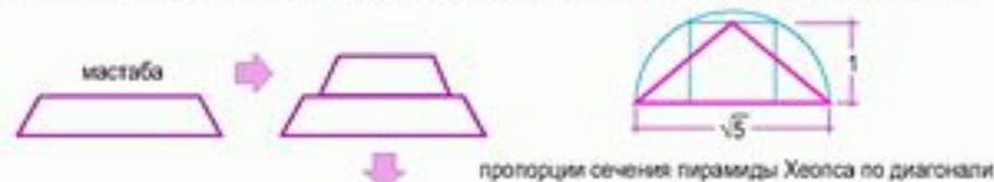
Выравнивание ярусов в единую наклонную плоскость приводит к традиционному типу пирамиды с пропорциями сторон – 5 : 4 : 3 "египетского треугольника" в диагональном сечении
