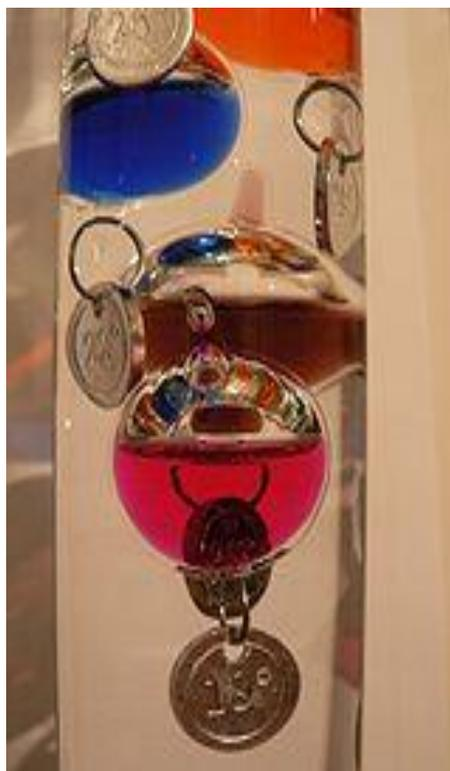
Термометр Галилея (современная модель)
