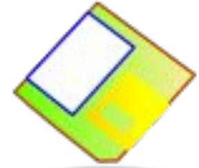
Стандартный гибкий диск (дискета) имеет сравнительно небольшую емкость (одной дискеты – **1.44 Мбайт**). По современным меркам этого совершенно недостаточно для большинства задач хранения и транспортировки данных.
