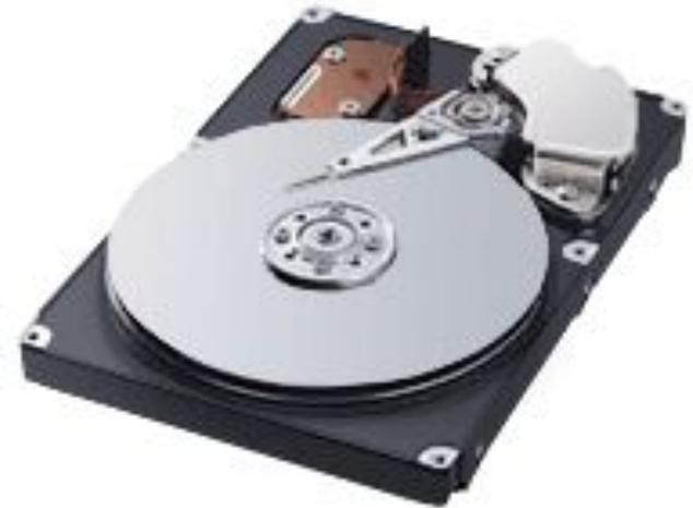
Жёсткий диск состоит из следующих основных узлов: корпус из прочного сплава, собственно жесткие диски (пластины) с магнитным покрытием, блок головок с устройством позиционирования, электропривод шпинделя и блок электроники. Принцип работы жестких дисков похож на работу магнитофонов.
