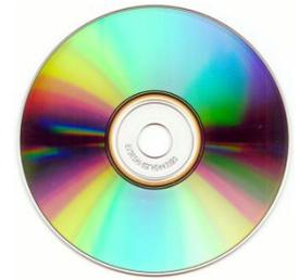
Для транспортировки бóльших объемов данных удобно использовать компакт-диски CD-ROM. Аббревиатура «CD-ROM» означает «Compact Disk Read Only Memory» и обозначает компакт-диск как носитель информации широкого применения. Емкость одного диска составляет порядка **650-700 Мбайт**.
