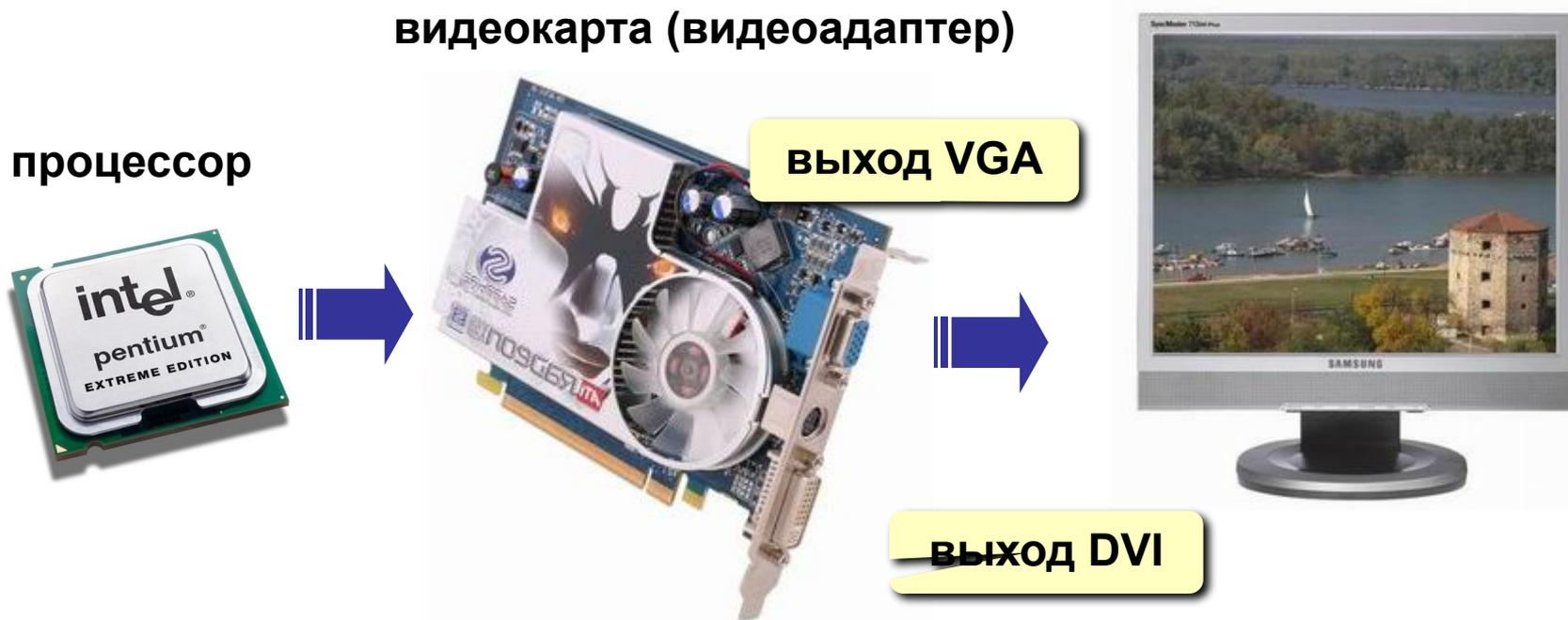
**Видеокарта** – это электронная плата, которая **обрабатывает** видеоданные и **управляет** работой монитора.
