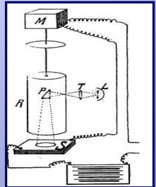
Механическое сканирование изображения осуществлялось по двум координатам и освещение каждой точки в отдельности.
