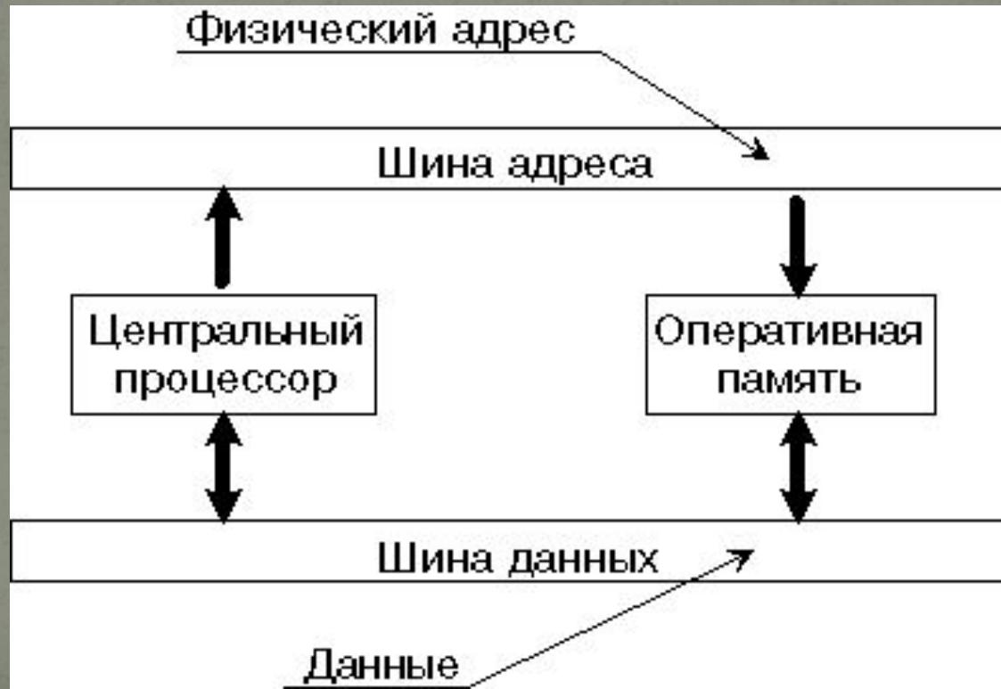
В компьютерах, собранных на базе процессоров Intel Pentium, шина данных 64-разрядная, то есть состоит из 64 линий, по которым за один раз на обработку поступают сразу 8 байтов.
