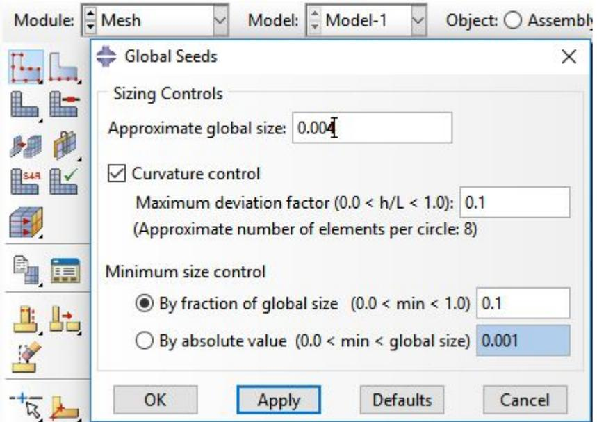
Также нам необходимо задать настройки для КЭ сетки, используя инструмент Assign Mesh Controls (предварительно выбрав саму деталь):
