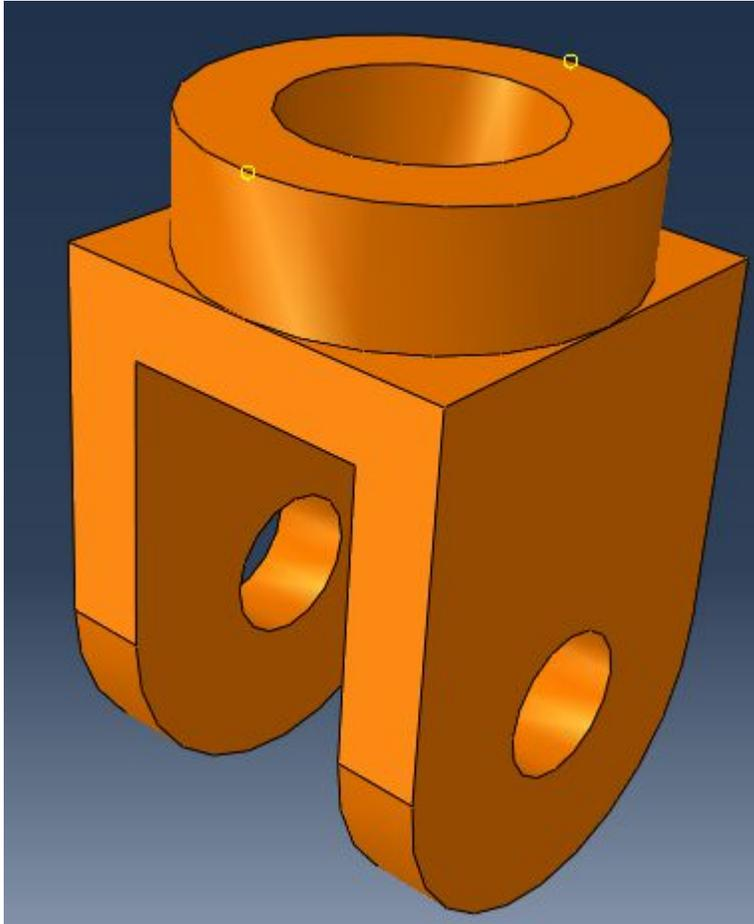
Далее необходимо разбить внешнюю поверхность данного буртика с помощью созданных точек. Для этого используем инструмент Partition Face: Use Shortest Path Between Two Points. Вначале выбираем поверхность и нажимаем Done, затем последовательно выбираем две точки, по которым будем
