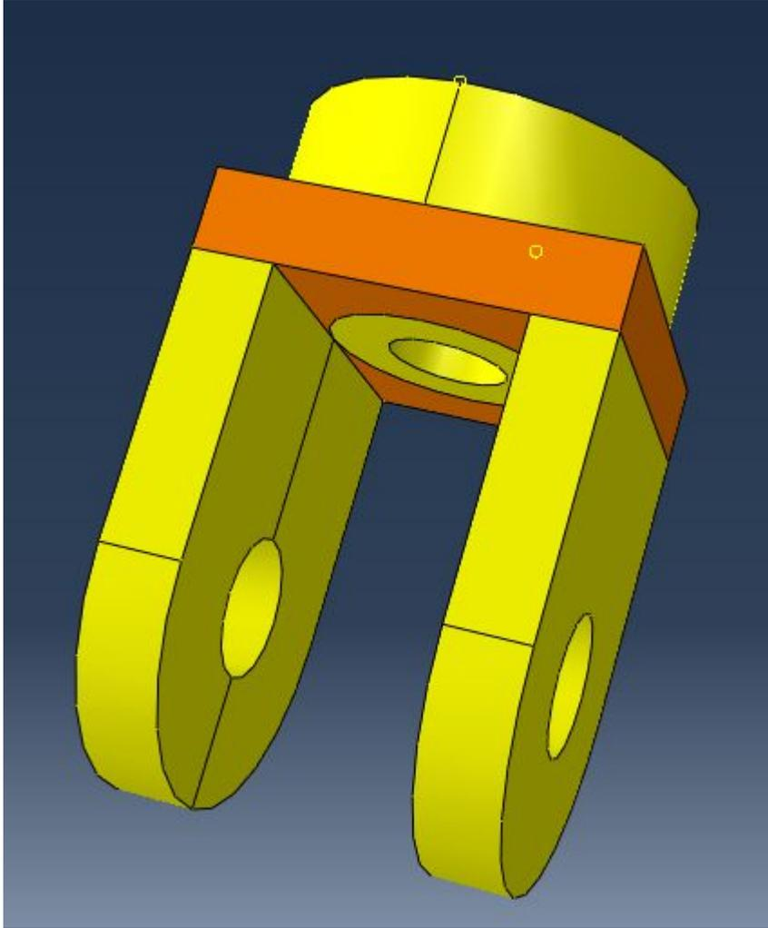
Далее нам необходимо дополнительно отрезать от средней пластины две части плоскостью, лежащей на внутренней поверхности кронштейнов, используя тот же самый инструмент Partition Cell: Extend Face:
