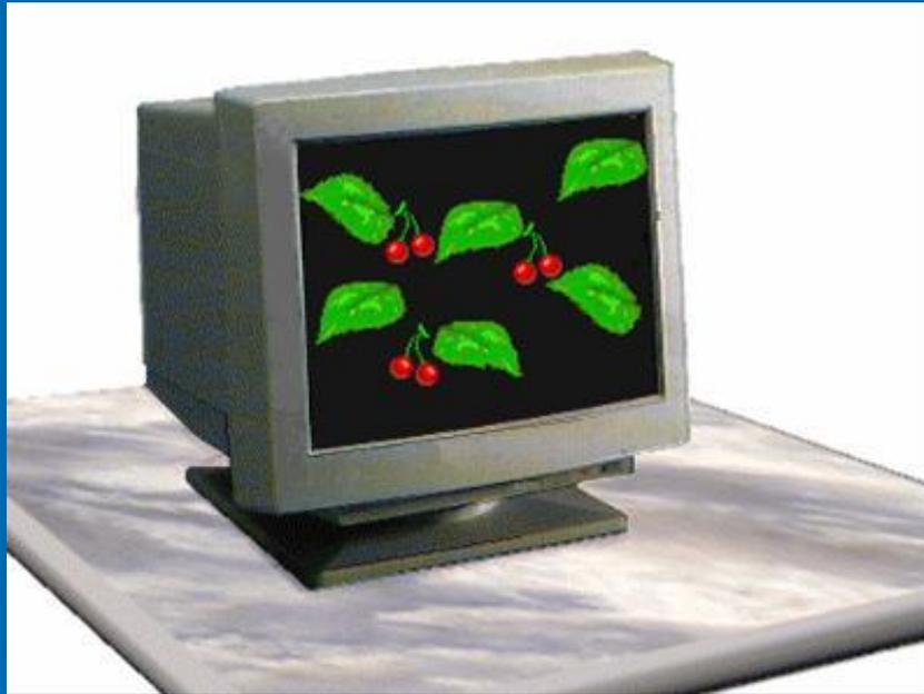
Монитор служит для общения компьютера с пользователем. На нем компьютер отображает текст и рисунки. Изображение на мониторе состоит из отдельных маленьких точек, называемых пикселями.
