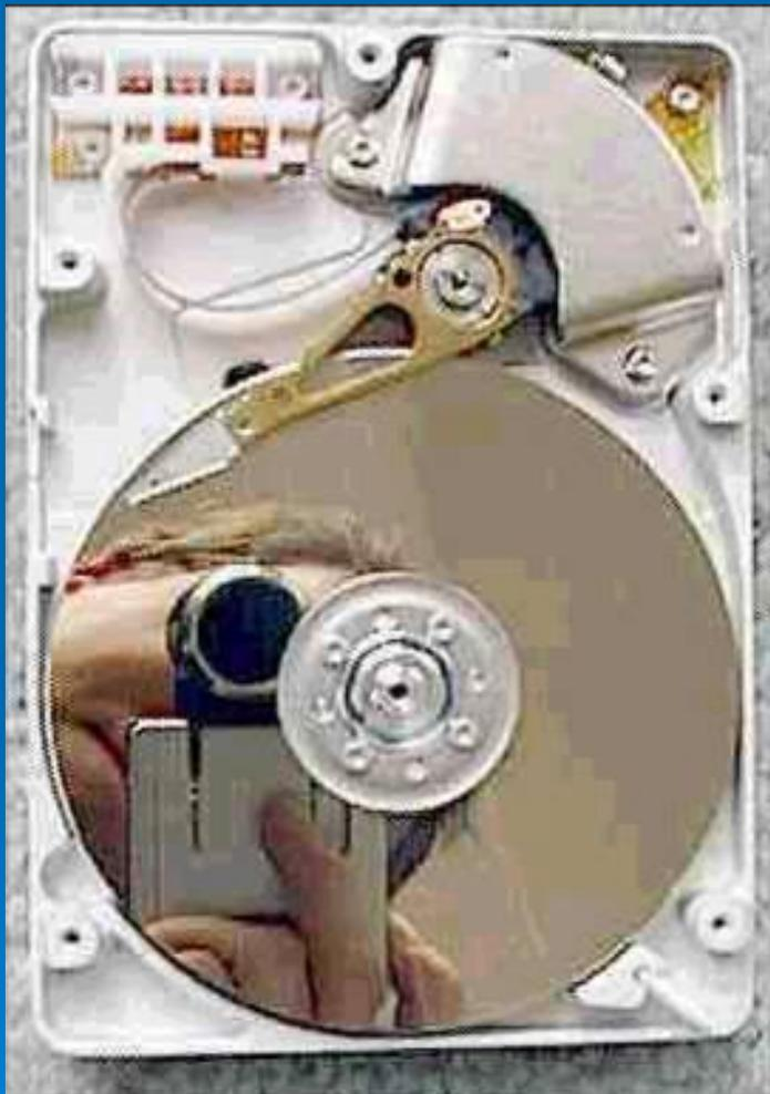
Жесткий диск встроен внутрь системного блока и постоянно находится там. Жесткий диск представляет собой набор металлических или керамических дисков, покрытых магнитным слоем.
