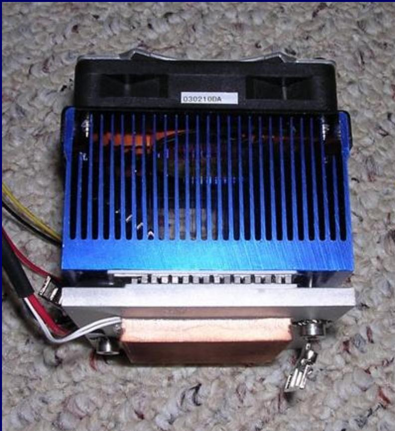
Элемент Пельтье — это небольшая пластинка, играющая роль «прокладки» между кристаллом процессора и куллером. Не вдаваясь в физические основы явления Пельтье, можно отметить, что эта пластинка позволяет поддерживать разность температур сторон пластиинки в районе 40°C при отдаваемых кристаллом процессора десятках ватт тепла
