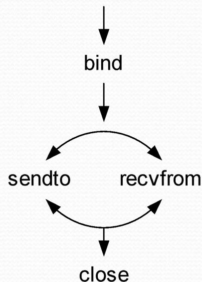
*Последовательность вызовов API, обеспечивающих взаимодействие процессов через дейтаграммные гнезда*
