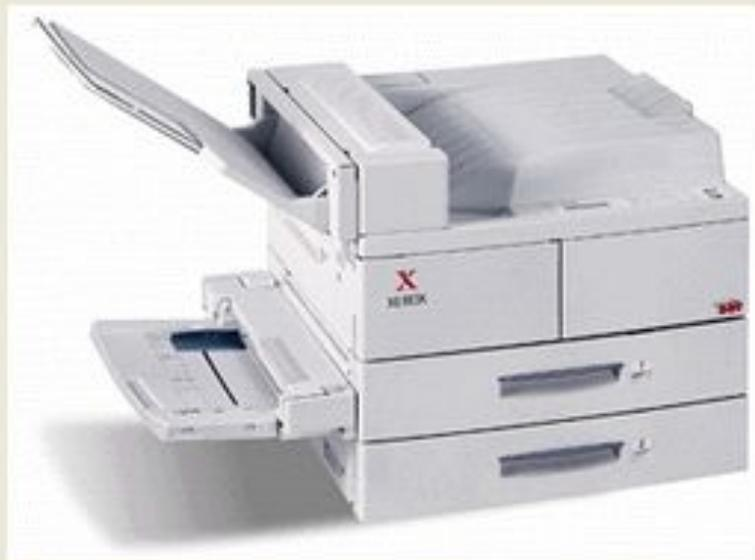
ЛАЗЕРНЫЕ ПРИНТЕРЫ обеспечивают в настоящее время наилучшее качество печати. В этих принтерах для печати используется принцип ксерографии: изображение переносится на бумагу со специального барабана, к которому электрически притягиваются частички краски.
