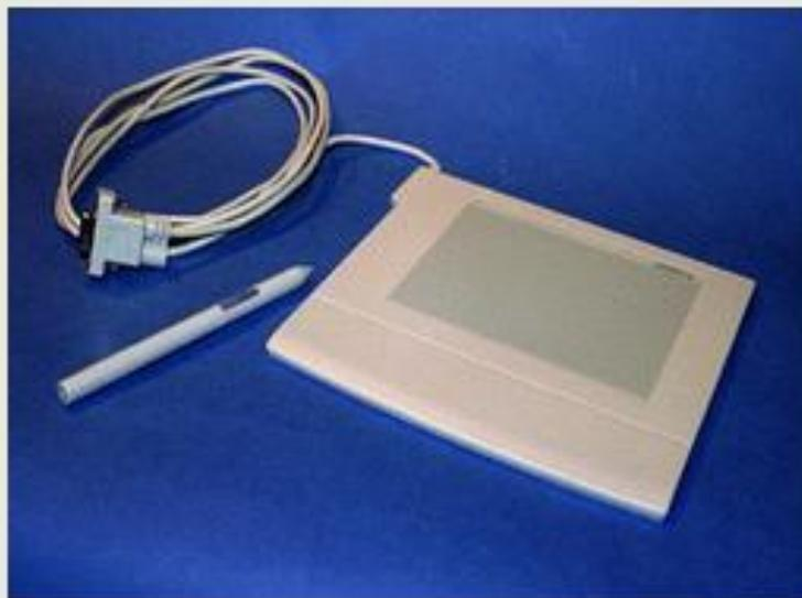
Графический планшет позволяет создавать рисунки так же, как и на листе бумаги. С помощью специального пера на поверхности планшета создается рисунок. Одновременно копия рисунка воспроизводится на экране.
