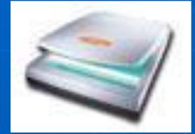
*В большинстве современных сканеров для получения данных об изображении применяется приемный элемент, называемый CCD (Charge-Coupled Device, прибор с зарядовой связью - ПЗС). Эта технология известна уже много лет и используется также в аппаратах факсимильной связи, видеокамерах и других устройствах.*
