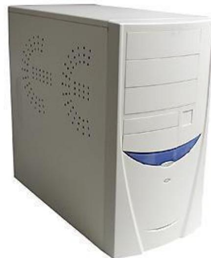
**Корпус компьютера предназначен для установки и закрепления в нём составных частей таких как материнская плата, видео карта, звуковая карта, внутренний модем и многого другого.**
