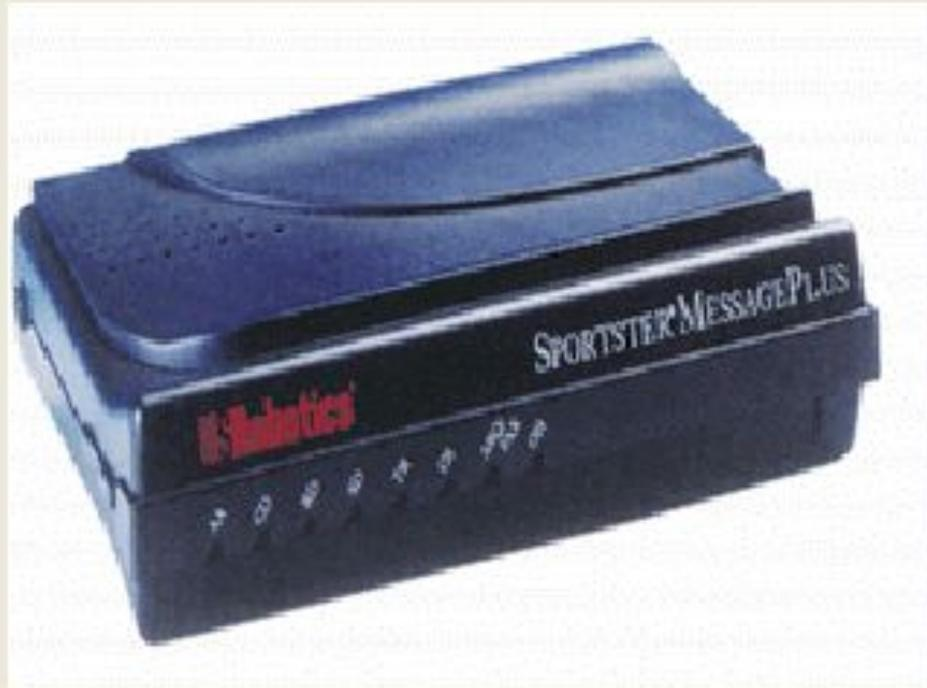
Обычно в качестве канала для передачи данных используют телефонную сеть, что требует преобразования выходной информации компьютера в сигнал, который может передаваться по телефонным линиям связи. Это преобразование осуществляет специальное устройство, называемое модемом. При получении информации из сети модем выполняет обратное преобразование информации,
