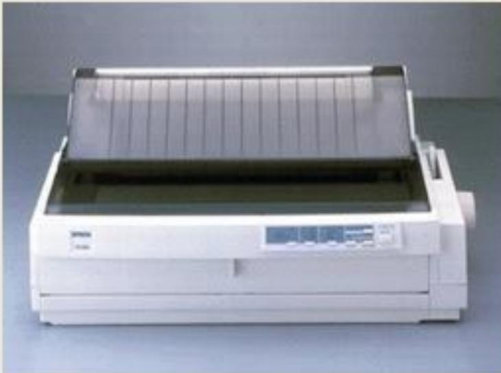
МАТРИЧНЫЕ (или точно-матричные) ПРИНТЕРЫ - наиболее распространенный тип принтеров для IBM PC.
