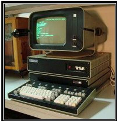
Классический вид компьютера — системный блок, дисплей, клавиатура (на фото - ДВК-2)
