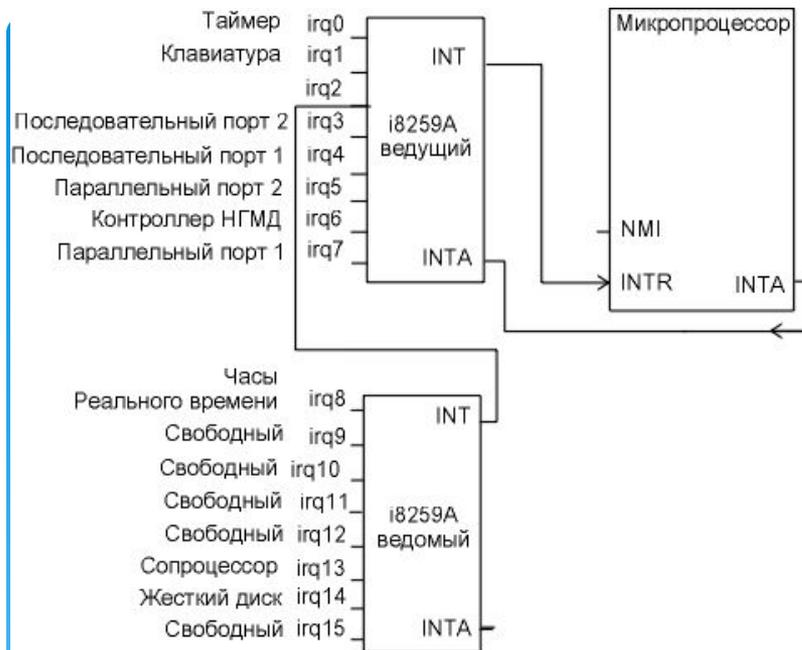
Внешние прерывания относятся, естественно, к непланируемым прерываниям. Внутренние прерывания возникают внутри микропроцессора во время вычислительного процесса. К их возбуждению приводит одна из двух причин:
