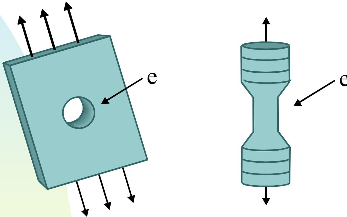
*Долговечность детали с концентратором сравнима с долговечностью образца, испытанного в условиях жесткого нагружения (измеренные деформации на образце соответствуют локальным деформациям в концентраторе – см. рис.)*
