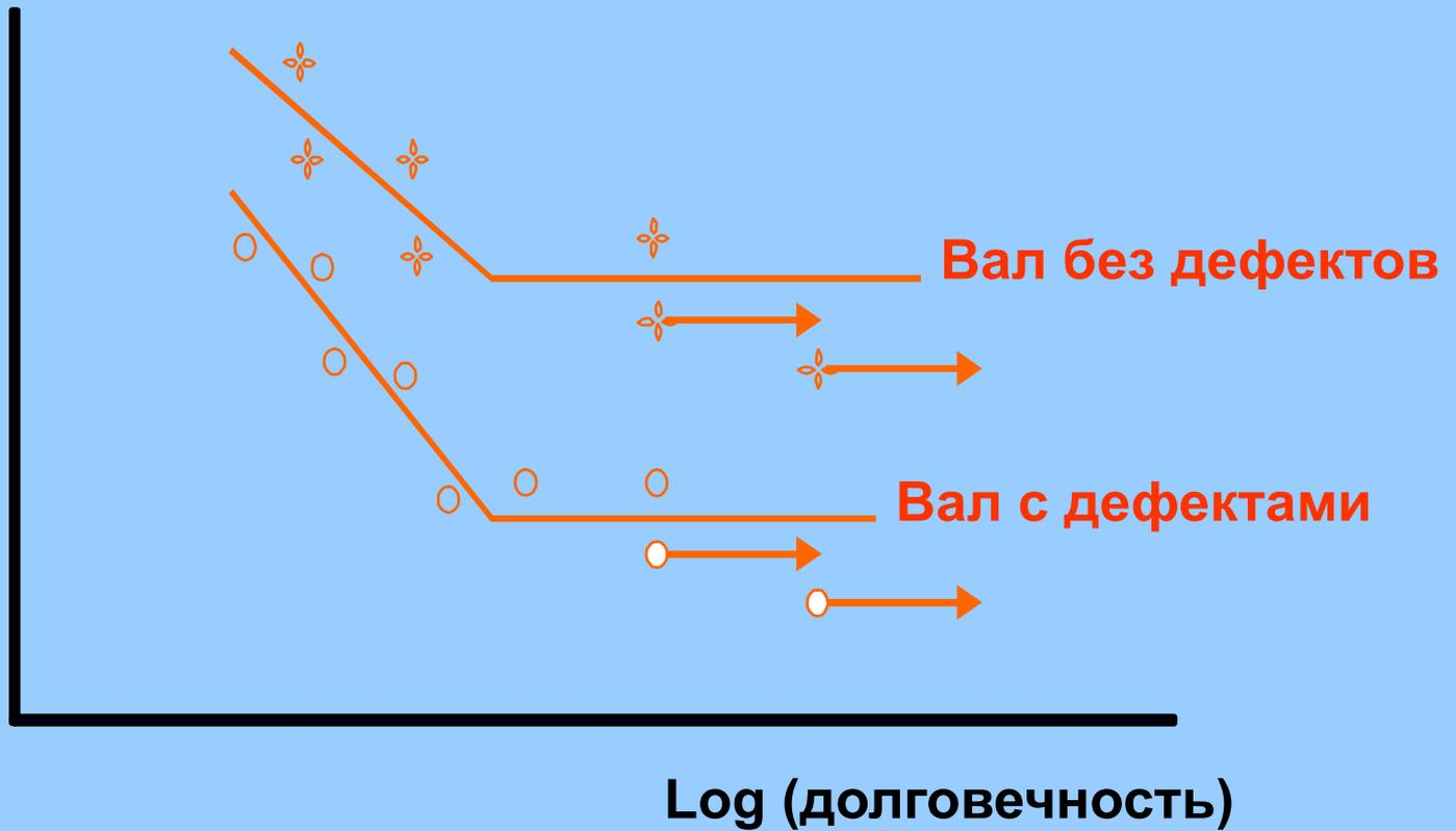
Типичные кривые Велера построенные при изгибно-крутильном циклическом нагружении
