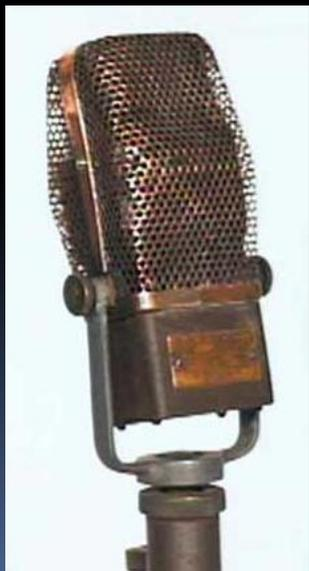
Первым динамическим микрофоном стал изобретённый в 1924 году немецкими учёными Э. Герлахом и В. Шоттки электродинамический микрофон ленточного типа. Такие микрофоны до сих пор применяются в студийной записи.
