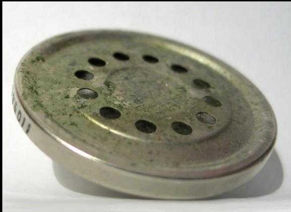
Вначале наибольшее распространение получил угольный микрофон Эдисона, об изобретении которого заявляли Г.Махальский в 1878 и П. М. Голубицкий в 1883. Угольный микрофон до сих пор используется в аппаратах аналоговой телефонии. Действие его основывается на изменении сопротивления между зёрнами угольного порошка при изменении давления на их совокупность.
