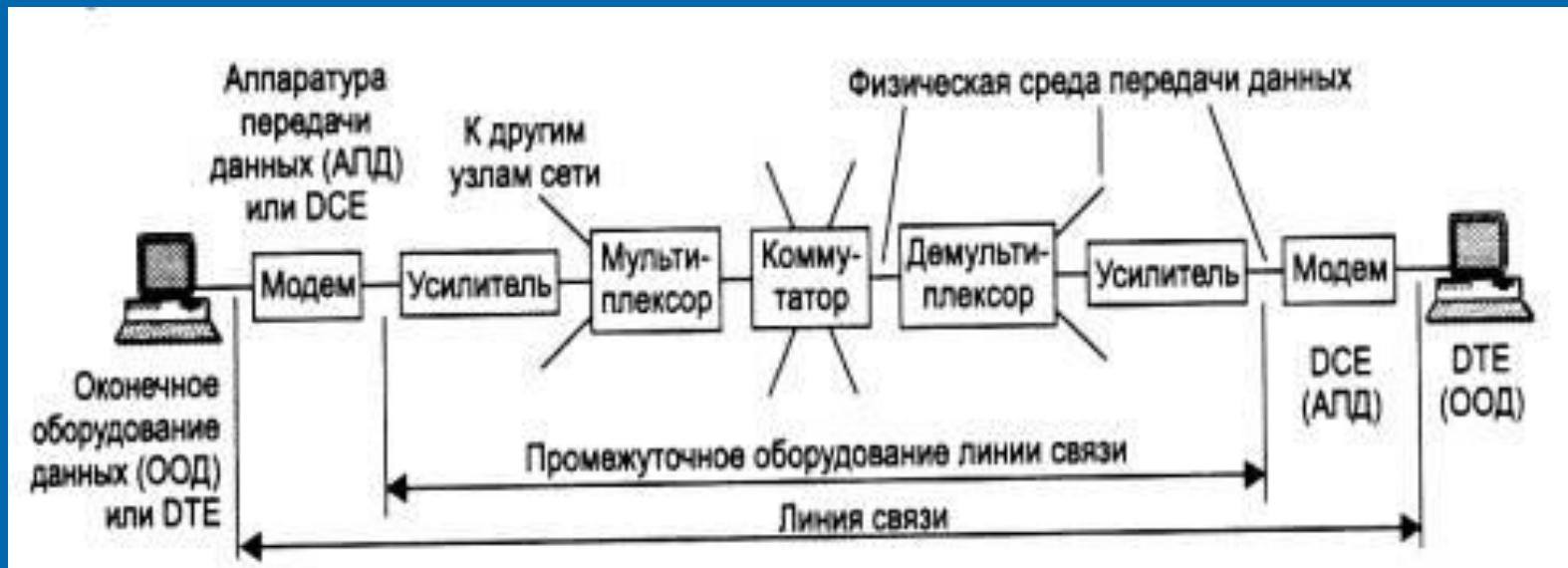
Линия связи состоит в общем случае из физической среды, по которой передаются электрические информационные сигналы, аппаратуры передачи данных и промежуточной аппаратуры. Синонимом термина линия связи (line) является термин канал связи(channel).
