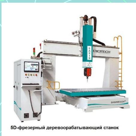
5D-фрезерный деревообрабатывающий станок
