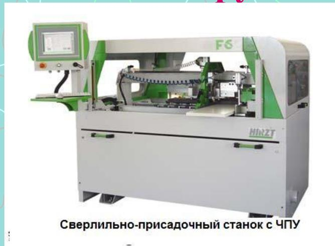
Сверлильно-присадочный станок с ЧПУ
