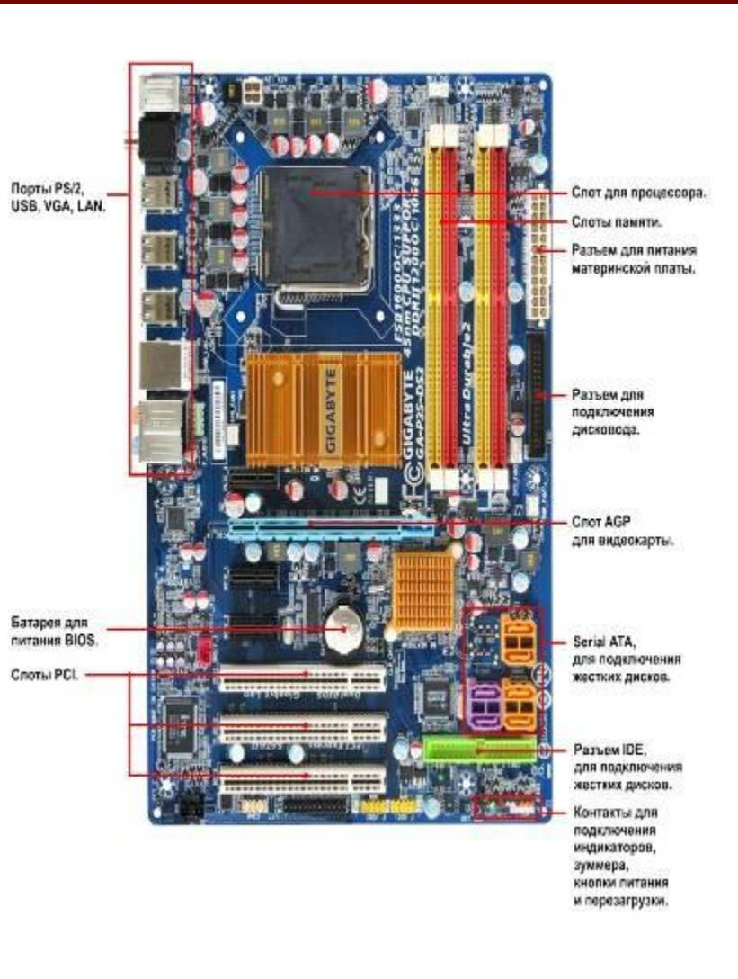
■ **Материнская плата** – основная часть системного блока, к которой подключены все устройства системного блока. Через материнскую плату происходит общение устройств системного блока между собой, обмен информацией, питание электроэнергией. Чем быстрее шины(каналы связи устройств) материнской платы, тем быстрей происходит общение устройств между собой, тем быстрее работает компьютер.
