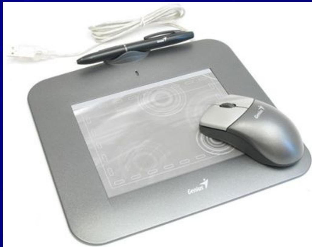
**Дигитайзеры большого размера используются, например, для ввода чертежей (формата А3 и более).**
