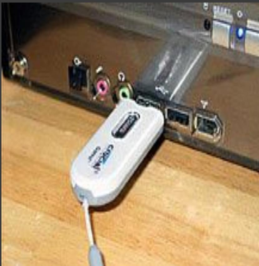
Для подключения к компьютеру используется либо обычный разъем USB на системном блоке (именно такие карты памяти чаще всего называют «флэшками»), либо специальный разъем на карт-ридере (Card Reader) — устройстве для чтения карт памяти.
