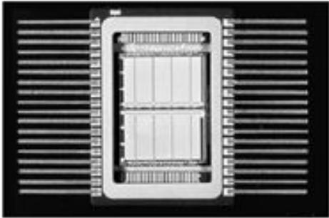
1971 г. Фирмой Intel (США) создан **первый микропроцессор** (МП) - программируемое логическое устройство, изготовленное по технологии СБИС.
