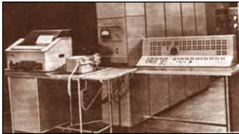
В 1959 г. выпущена отечественная вычислительная машина **Сетунь**, работающая в троичной системе счисления.
