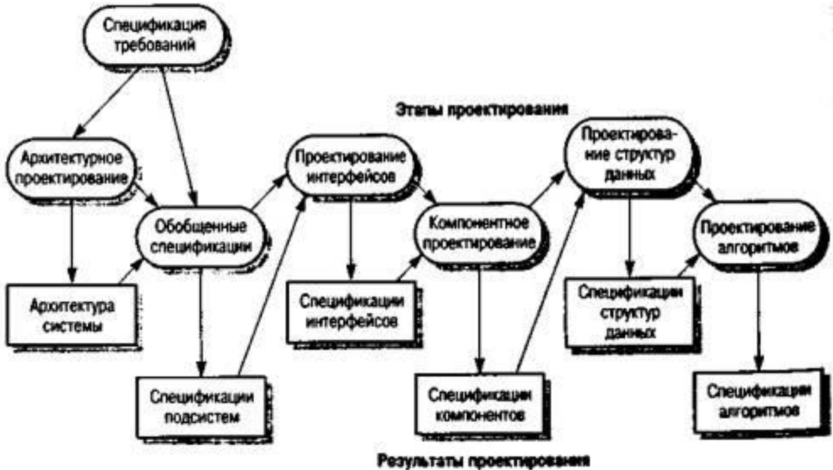
Рис. 3.9. Обобщенная схема процесса проектирования
