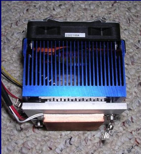
Элемент Пельтье — это небольшая пластиинка, играющая роль «прокладки» между кристаллом процессора и куллером. Эта пластиинка позволяет поддерживать разность температур сторон пластиинки в районе 40°C при отдаваемых кристаллом процессора десятках ватт тепла. Достать модули легко, пара мощных Дрифт0.8 от Криотерма обойдется чуть менее полутора тысяч с доставкой. Но достать подходящий кулплейт — медную прокладку габаритами 10см\*5см\*1см минимум — трудно.
