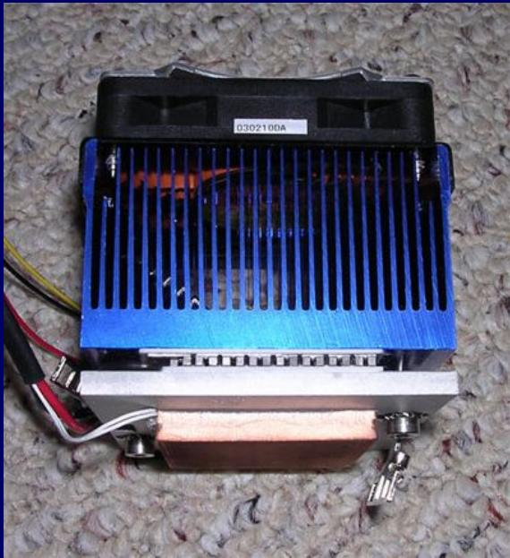
Элемент Пельтье — это небольшая пластиинка, играющая роль «прокладки» между кристаллом процессора и куллером. Эта пластиинка позволяет поддерживать разность температур сторон пластиинки в районе 40°С при отдаваемых кристаллом процессора десятках ватт тепла. Достать модули легко, пара мощных Дрифт0.8 от Криотерма обойдется чуть менее полутора тысяч с доставкой. Но достать подходящий кулплейт — медную прокладку габаритами 10см\*5см\*1см минимум — трудно.
