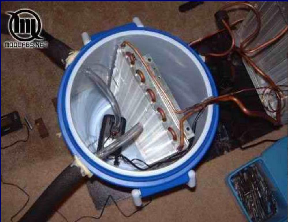
Ватерчиллер – это система охлаждения, призванная снизить температуру объекта ниже температуры окружающей среды вплоть до отрицательной.
