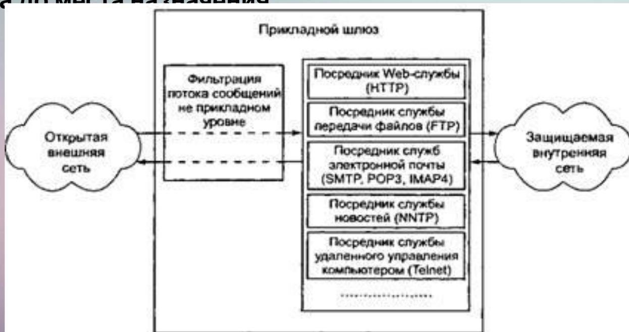
Рис. 9.6. Схема функционирования прикладного шлюза
