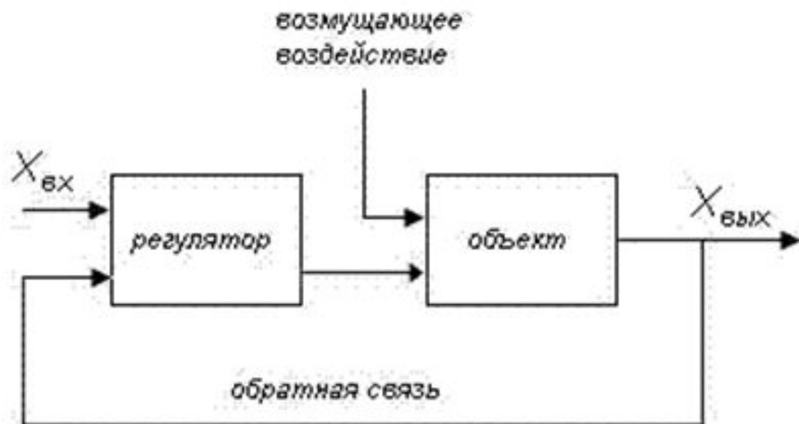
Принцип отклонения управляемой переменной в ТАУ
