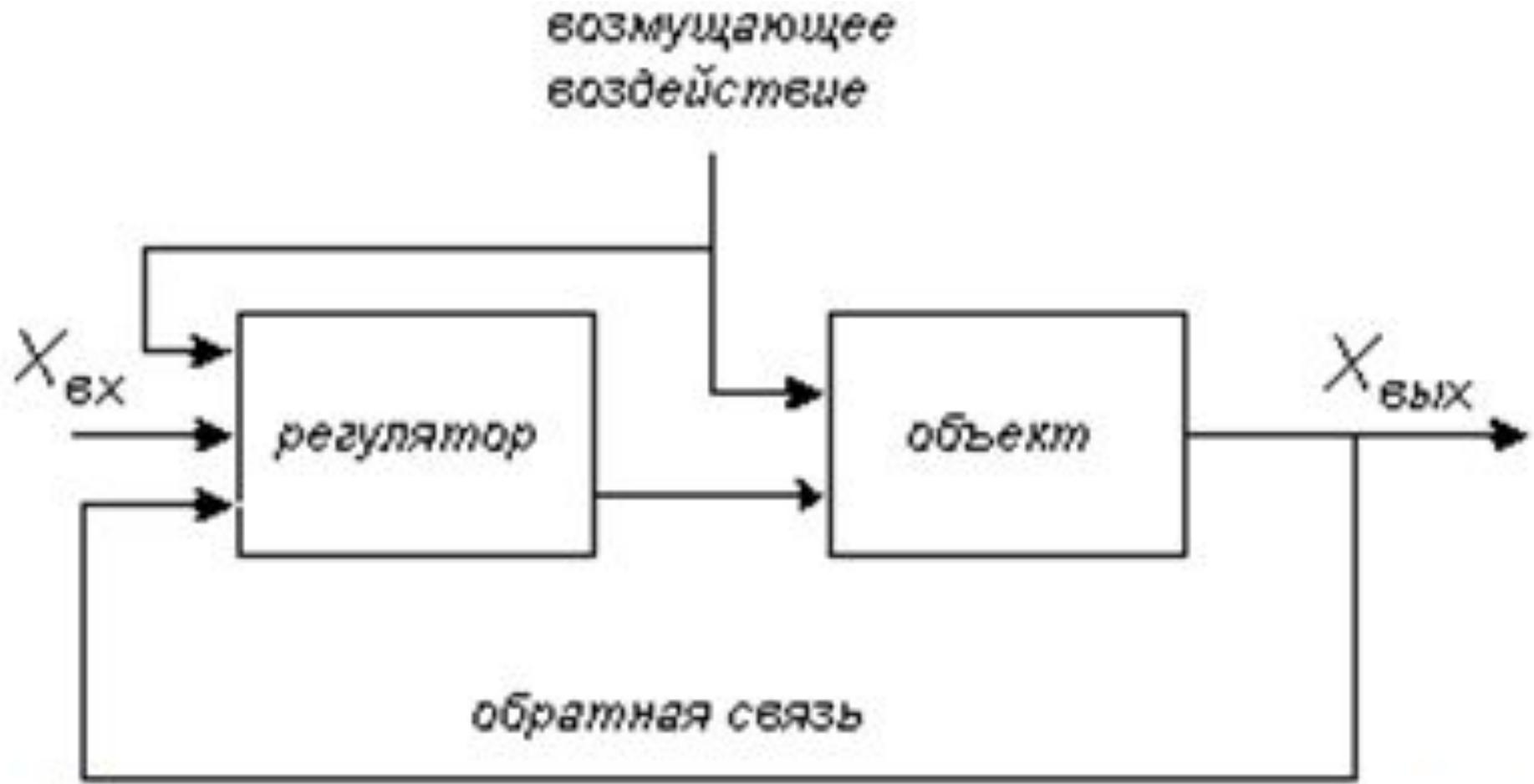
**Принцип комбинированного регулирования в ТАУ**
