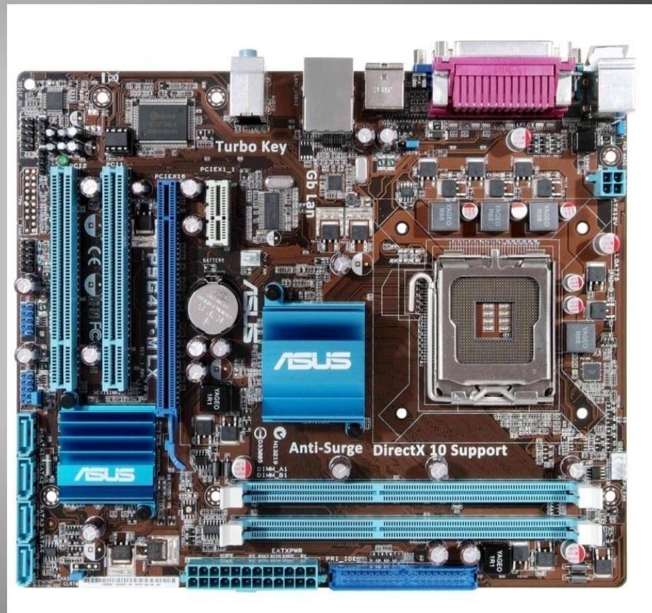
Северный Мост определяет частоту системной шины, возможный тип оперативной памяти (SDRAM, DDR, другие), ее максимальный объем и скорость обмена информацией с процессором. Кроме того, от Северного Моста зависит наличие шины видео адаптера, ее тип и быстродействие. Для компьютерных систем нижнего ценового уровня в Северный Мост нередко встраивают и графическое ядро. Во многих случаях именно Северный Мост определяет тип и быстродействие шины расширения системы (PCI, PCI Express, другое).
