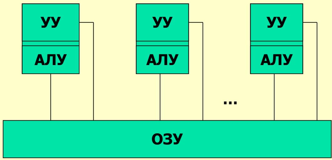
Рис. 1. Архитектура многопроцессорного компьютера
